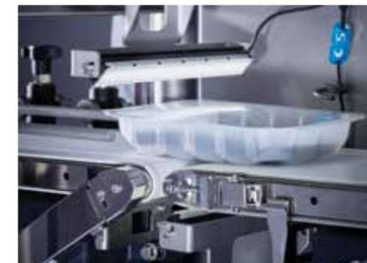
Para supervisar al completo las etiquetas de los envases, puede montarse un sistema de visión en la plataforma QC220.
