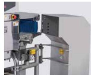
El diseño del contenedor de rechazo y de protección permite un fácil acceso.
