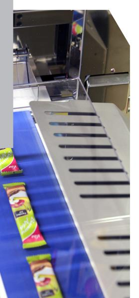
Après avoir soumis plusieurs fabricants de détecteurs par rayons X à une rigoureuse batterie de tests, la société allemande VIBA a sélectionné le modèle EN développé par le constructeur ISHIDA. Le système est dédié à la surveillance de barres de fruits dont la gamme atteint plus de 60 recettes, différentes tailles d'emballage pour des poids allant de 8 à 50 g.
