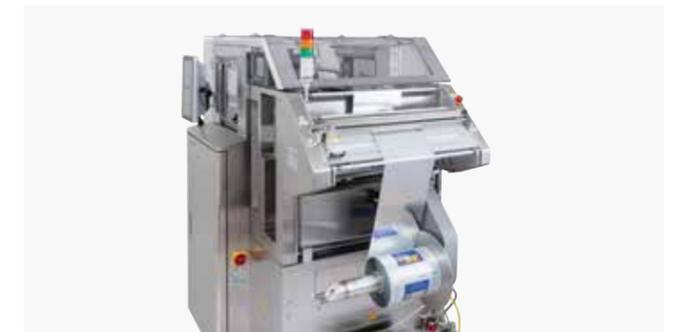
Le choix de la peseuse surmontée d'une ensacheuse permet de réduire l'encombrement et convient à la plupart des installations des clients.
