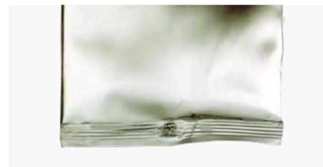
La détection de la présence de produit dans la soudure est une technologie Ishida qui permet d'identifier avec précision les éventuels défauts de soudure sur toute la largeur de la mâchoire.
