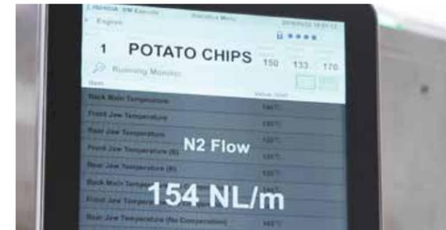
Un débitmètre associé à une valve électropneumatique délivre dans chaque sachet la quantité d'hydrogène préreglée, réduisant les gaspillages de gaz tout en garantissant la qualité de l'étanchéité.
