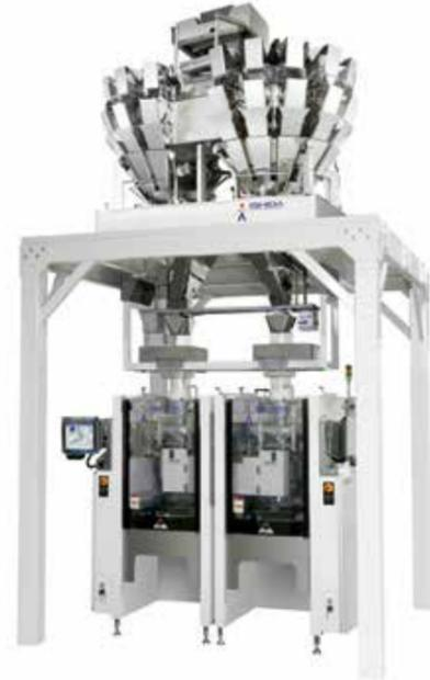
Ishida bietet Geräte zum Wiegen und Verpacken einer breiten Palette von Snacks, Lebensmitteln und Verpackungsarten an. Wir liefern auch Kombinationen aus einer Ishida-Waage und einer Ishida Schlauchbeutelmaschine (mit Spezialausrüstung) oder unsere Ishida-Mehrkopfwaage als Teil einer abgestimmten Lösung mit unseren OEM-Partnern für Beutelmaschinen.
