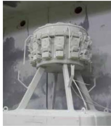
Staubprüfung für IP6X
