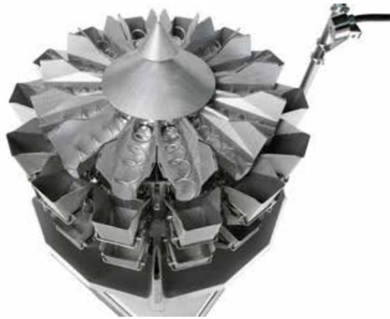
Die Ishida Spiralförderer Mehrkopfwaagen sind ideal zum Wiegen von klebrigen, öligen und marinierten Produkten geeignet, da sie speziell für schwer bewegliche Frischeprodukte konzipiert wurde. Die kernlose Edelstahlspirale bewegt das Produkt auf der Mehrkopfwaage sanft aber sicher in Richtung des robusten Trichtersystems, das ein Verkleben des Produkts verhindert und eine hervorragende Leistung gewährleistet.
