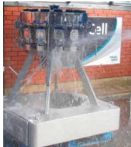
Fortlaufender Test mit starkem Strahlwasser für IPX6
