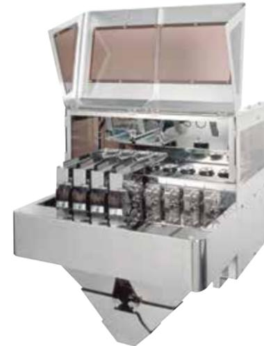
Diese exklusiv von Ishida hergestellten linearen Mehrkopfwaagen eignen sich ideal für Anwendungen mit niedrigen Zielgewichten wie Süßwaren, Nüssen, getrockneten Suppenzutaten und getrocknetem Gemüse. Sie bieten ein besonders schonendes Produkthandling bei hohen Geschwindigkeiten und sind eine hervorragende Lösung für die Mischverwiegung von niedrigen Zielgewichten.
